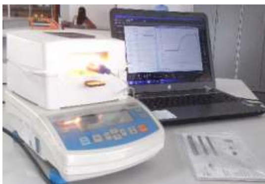
Figura 5 Analizador de humedad Radwag PMC, utilizada para medir la humedad en los granos de cacao.
