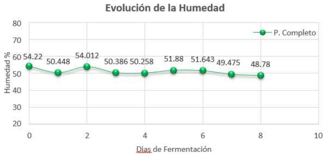
Figura 16 Evolución del humedad durante la fermentación en el fermentador – Lote 1
