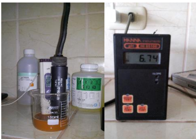
Figura 6 Indicador de pH HANNA Instruments HI8510E, utilizado para medir el pH en los granos de cacao.
