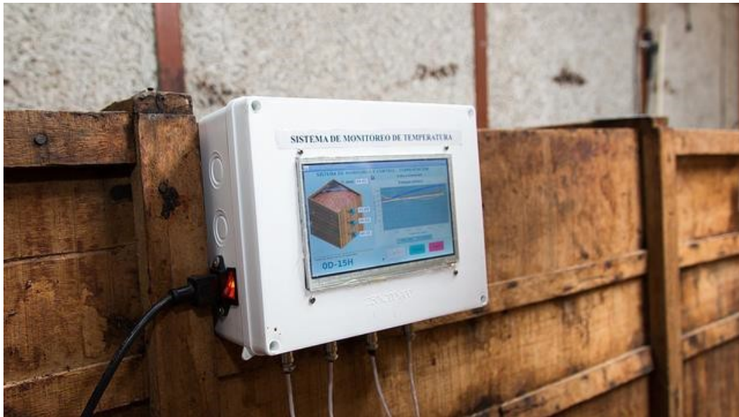
Fig. 14. Prototipo instalado en sala de fermentación
